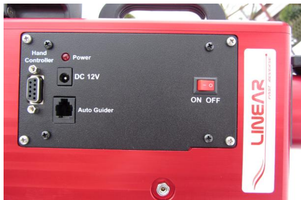
Anschlussplatte mit ST4 kompatibelem Guidereingang
